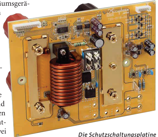
Die Schutzschaltungsplatine arbeitet mit sehr niederohmigen MosFets und einer Flachdraht-Luftspule
